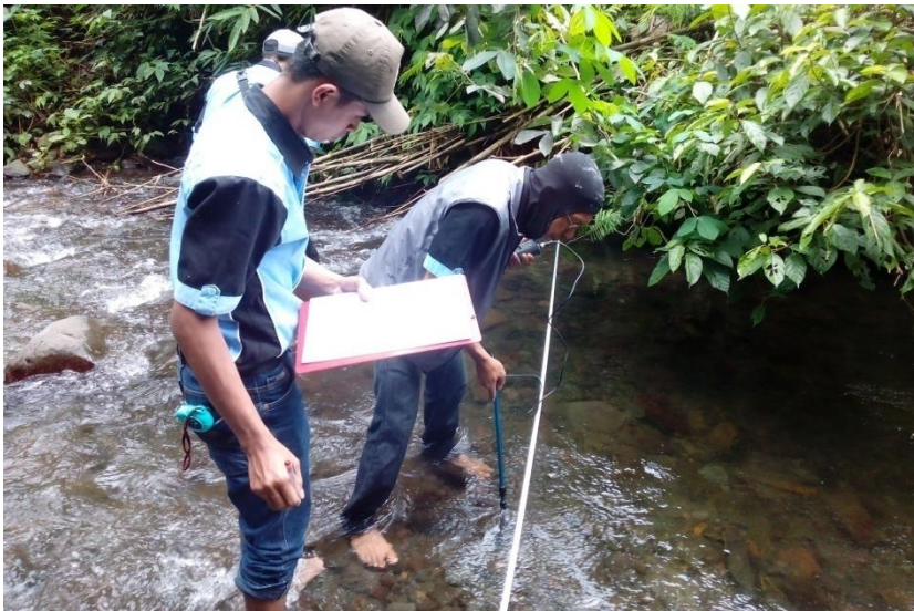
Gambar 5.3. Pengukuran kecepatan aliran air menggunakan current meter (Dokumentasi Pribadi, 2020)
