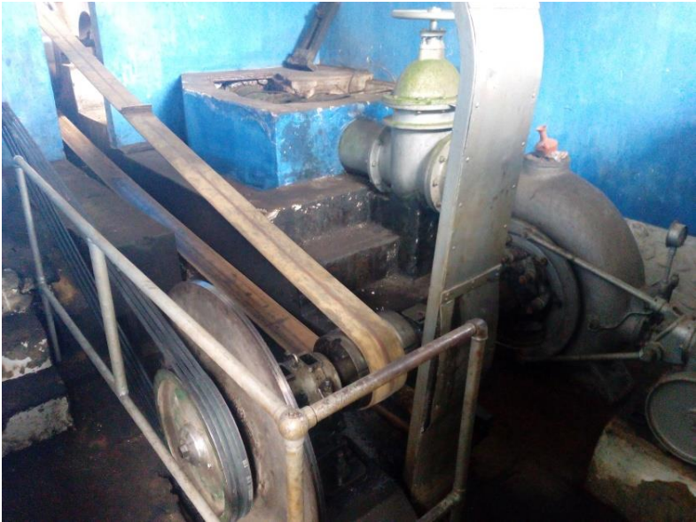
Gambar 5.10. Mikrohidro Turbin Francis di Perkebunan Gunung Pasang Jember (Dokumentasi pribadi, 2018)
