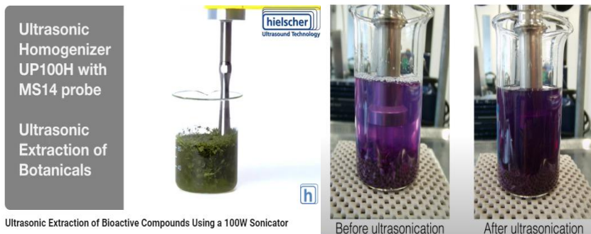
Gambar 6.1. Aplikasi ultrasonikasi untuk ekstraksi senyawa bioaktif ( https://www.youtube.com/hielscher )
