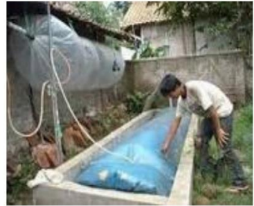
Gambar 9.3. Reaktor tipe balon
