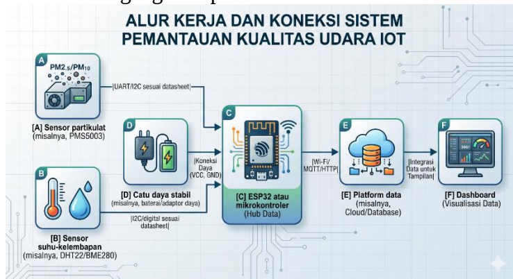
Gambar 6. 2 Skema konseptual rangkaian sistem pemantauan kualitas udara
