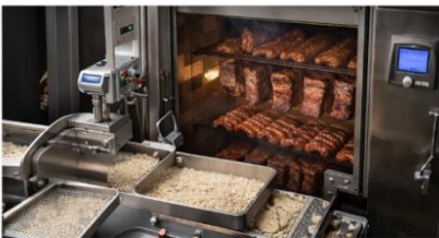
Figure 3. Oven pengasap mbern dengan sistem kendali suhu- dan kelembapan untuk produksi daging asap.
