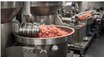
Figure 1. Lini produksi sosis industri yang menunjukkan proses, penggilingan, pencampuran, dan pengisian adonan setaus terkontrol.
