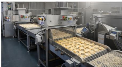
Figure 2. Sistem otomatis pembetmuban dan pelapisan nugget daging dalam industri pengolahan pangan.
