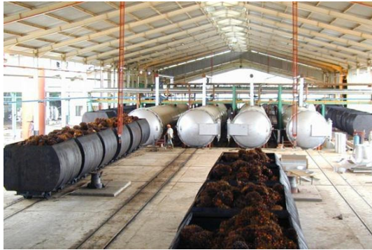
Gambar 4.8. Proses sterilisasi pabrik kelapa sawit
