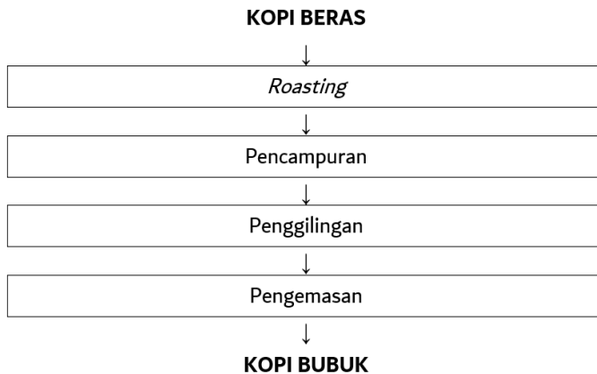
Gambar 9.2. Proses pengolahan kopi bubuk (Suratno, 1992)
