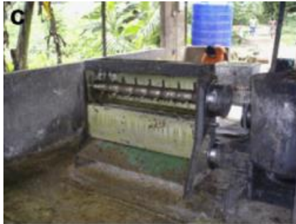
Gambar 4.1. Peralatan/mesin pengolah yang diamati pada pabrik kecil, drum untuk memasak buah-buahan (a); reaktor vertikal (b); mesin press yang dioperasikan dengan tangan (c); pemisah mur/serat.
