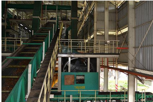
Gambar 4.9. Proses perontokan pabrik kelapa sawit
