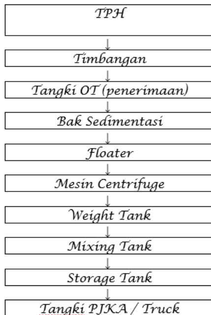
Gambar 8.1 Flow Proses Pengolahan Lateks Pekat dari lateks cair segar
