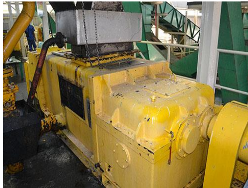
Gambar 4.10. Proses pengepresan pabrik minyak sawit
