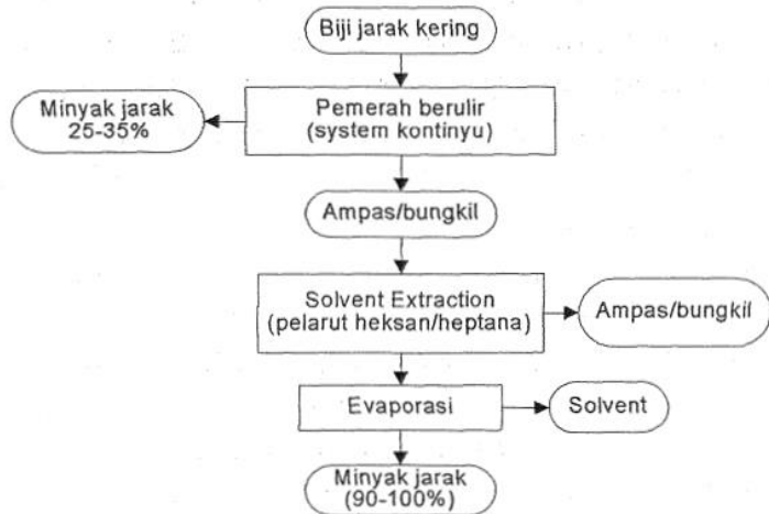
Gambar 10.2 Proses Ekstraksi Minyak Jarak dengan Metode Kombinasi (Prakoso, 2005)
