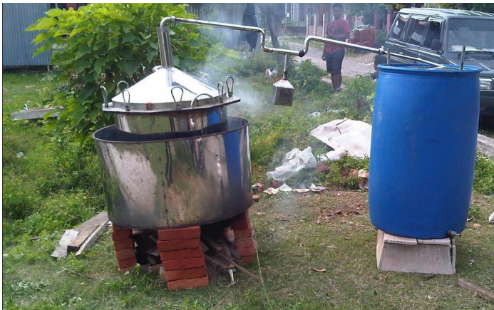
Gambar 2.9. Peralatan pirolisis pembuat asap cair (dokumentasi pribadi)
